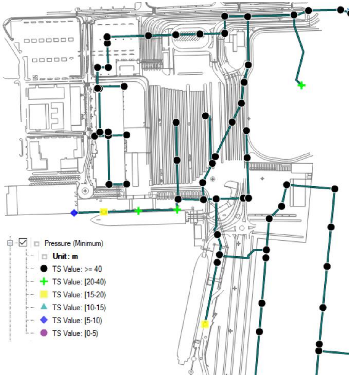
Figur 5. Utformning av befintligt system av brandvattenförsörjning inom området samt aktuella flödeskapaciteter.
